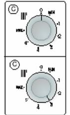
В летнем режиме котел работает только на приготовление горячей воды. Выбор режима работы осуществляется ручкой «C» панели управления котла. Установив ручку «C» в положение «O», вы выбираете летний режим работы котла. Зимний режим выбирается при установке ручки «C» в любое промежуточное положение между отметками «min» и «max»
